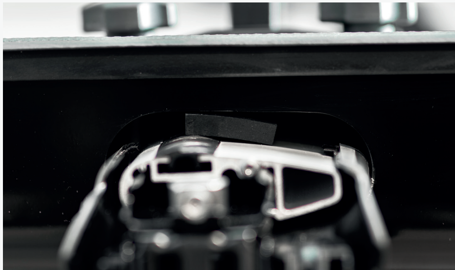
Distansekloss plassert i tunell før deksel til stativet settes på plass
