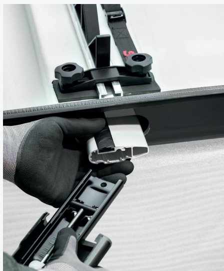
Stativet føres igjennom tunellen
