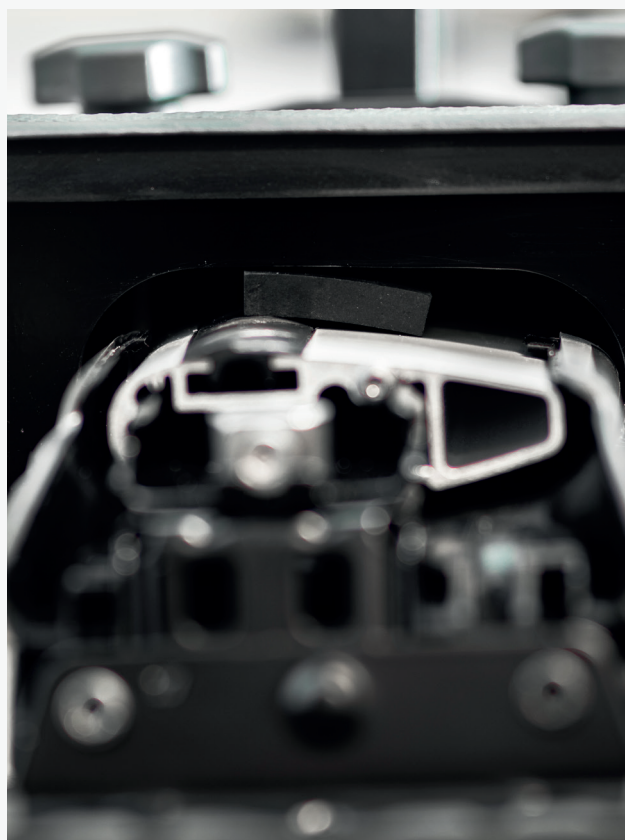
Distansekluss plassert i tunell før deksel til stativet settes på plass
