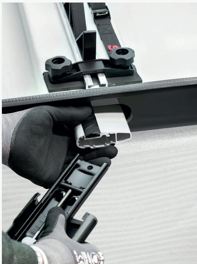
Stativet føres igjennom tunellen
